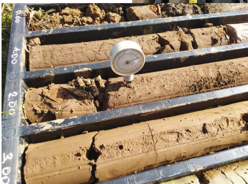
Prova con Pocket Penetrometer
