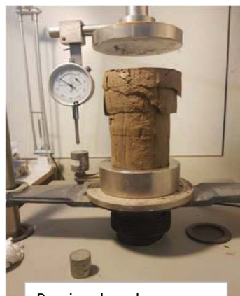
Provino dopo la prova
